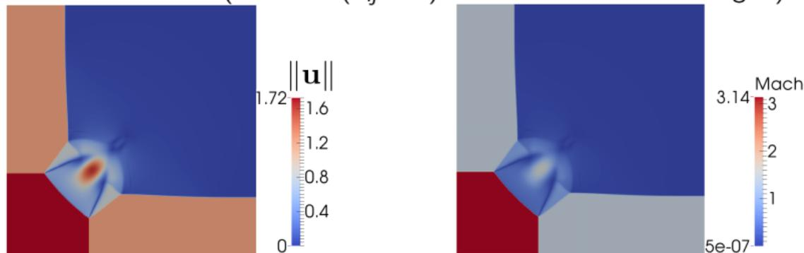
$\kappa_{ij} = 1$  and  $\kappa_{ij} = \min\left(1, \frac{|u_{ij}|}{c_{ij}}\right)$  (AM) on a 40 000 triangular mesh :
